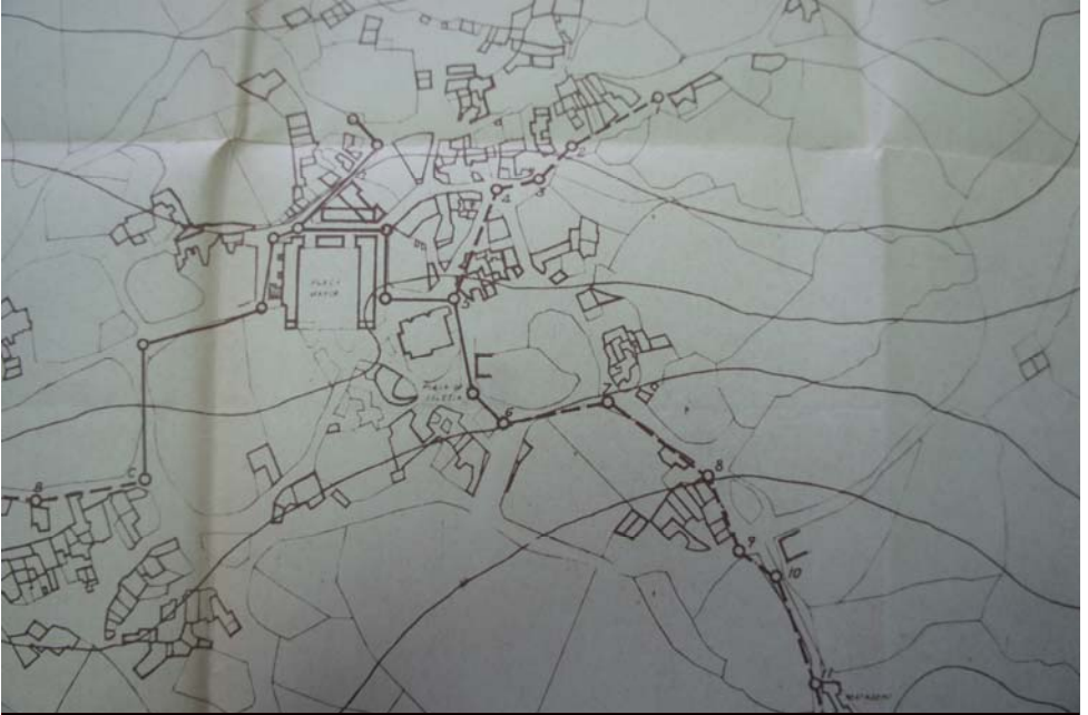
Plano del proyecto de saneamiento de 1955, detalle del casco histórico. En línea continua la primera fase y discontinua la segunda. (AMHM Sig. 876/1. Servicios comunitarios. 1948-1954)
